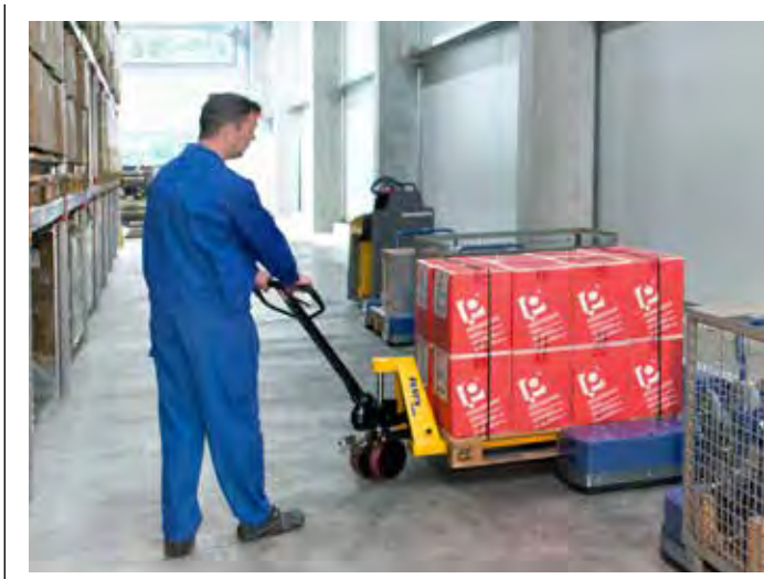
Be- und Entladung mittels Gabelhubwagen
